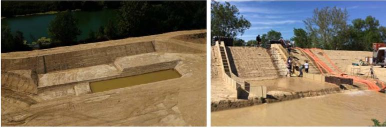
FIGURE 1 : VUE AERIENNE DE L'OUVRAGE DEMONSTRATEUR APRES REALISATION (GAUCHE) // ESSAIS DE SURVERSE *IN SITU* (DROITE)
